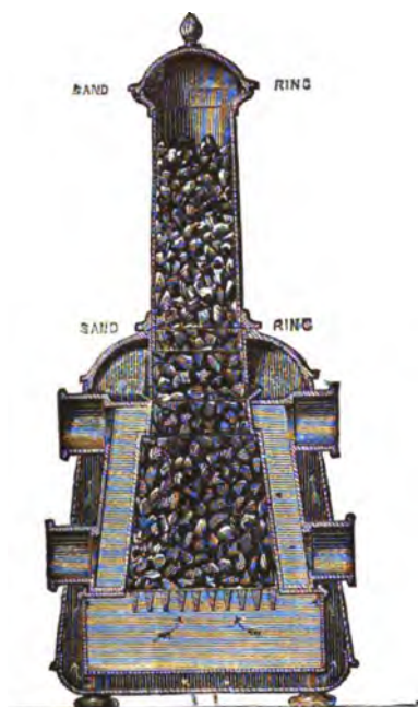
Fig. 18. — Chaudière brevetée Dennis à monture transportable et à courant d'air chaud.
